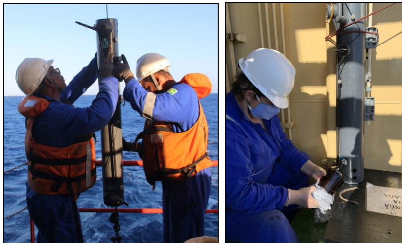
Figura 6: Lançamento de garrafa oceanográfica (GO-FLO) durante a 17ª Campanha do Projeto de Monitoramento Ambiental nos Campos de Bijupirá & Salema.
