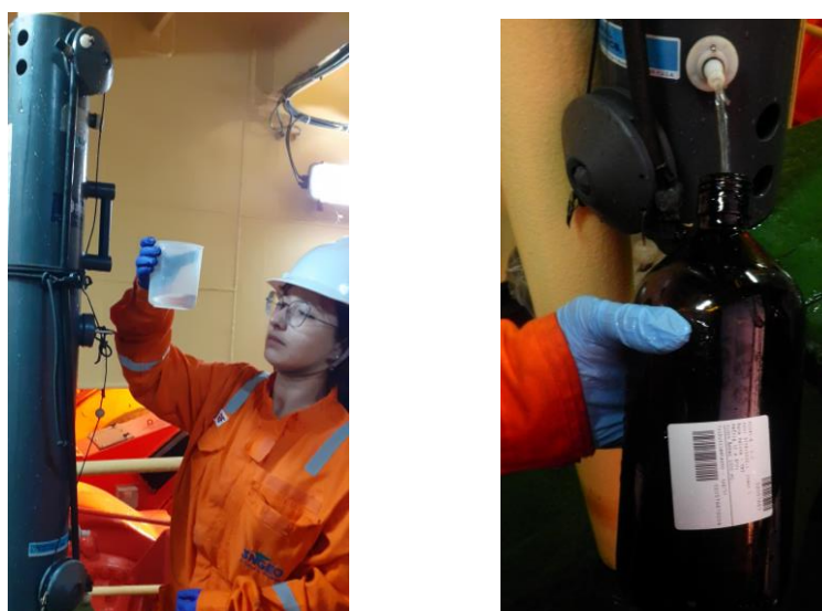
Figura 8: Amostragem de parâmetros a partir do desmame de garrafa oceanográfica, para o Monitoramento Ambiental do Parque das Conchas, Bacia de Campos.
