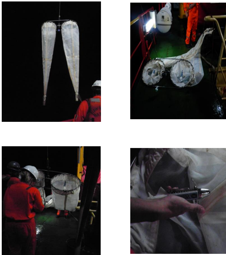
Figura 11 – Em sequência, rede de plâncton do tipo bongô durante a 12ª campanha de Monitoramento Ambiental do Parque das Conchas, Bacia de Campos.
