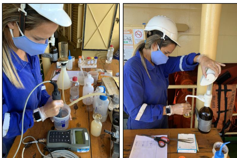
Figura 7: Equipamentos utilizados na medição dos parâmetros físico-químicos in situ e na filtração durante a 17ª Campanha do Projeto de Monitoramento Ambiental nos Campos de Bijupirá & Salema.
