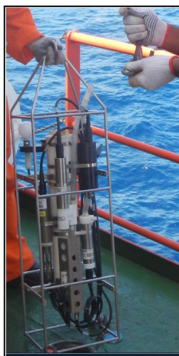
Figura 5: Lançamento de CTD durante a 16ª Campanha do Projeto de Monitoramento Ambiental nos Campos de Bijupirá & Salema.
