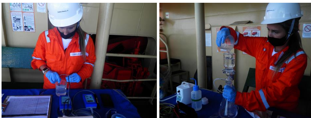
Figura 7: Equipamentos utilizados na medição dos parâmetros físico-químicos in situ e na filtração para o Monitoramento Ambiental do Parque das Conchas, Bacia de Campos.
